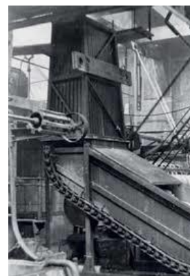
A folyamatos kötegféheítő gépsor részlete
